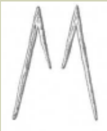
Рис. 3. Крюки (рогульки) для свивания веревок
